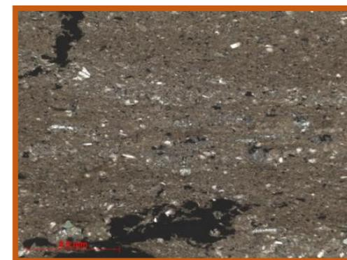
Аргиллит с алевритовой примесью неравномерно пиритизированный с мелким углефицированным растительным детритом. Фото илфа без анализатора.
